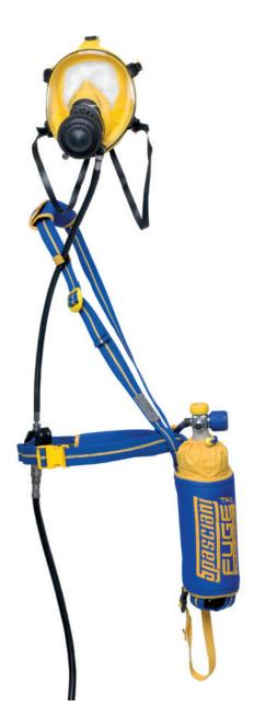
**FUGE TAIL** è un autorespiratore ad aria compressa per la fuga (Emergency Escape Breathing Device) che in caso di emergenza fornisce un flusso di aria respirabile, a domanda, per un tempo minimo garantito di **15 minuti**. E' destinato all'uso in tutti gli ambienti in cui si possono verificare situazioni pericolose dovute alla presenza di fumi di incendio o mancanza di ossigeno.
